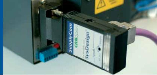
**SupplyCom ist ein Interface für die direkte Kommunikation mit analog programmierbaren Netzgeräten über CANopen, PROFIBUS DP oder RS-232-Schnittstelle.**
