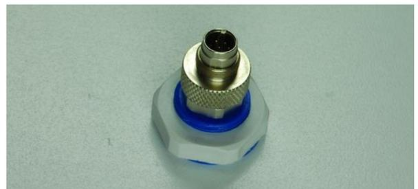
Kommunikationsadapter (Transceiver RS232) aufstecken und Sicherungsmutter handfest anziehen.
