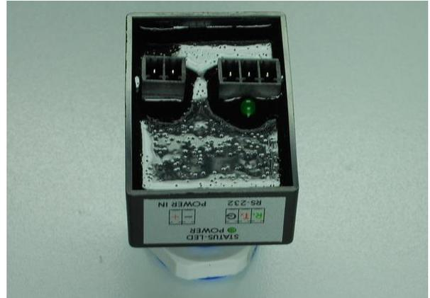
Anschlusskabel für Spannungsversorgung aufstecken, Schnittstellenkabel anschließen.
