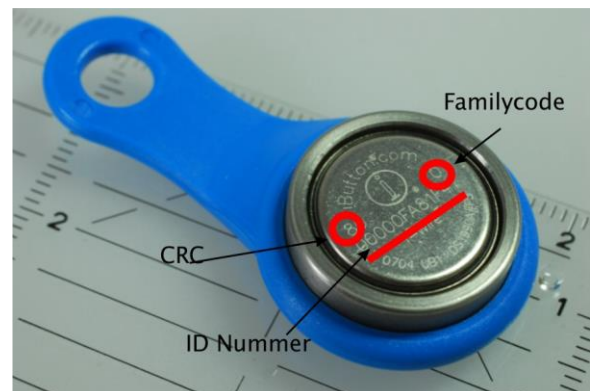
Abbildung 4: Bedeutung der aufgelaserten Beschriftung des Schlüssels
