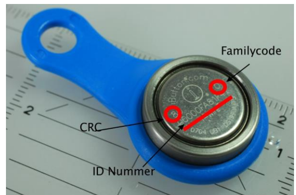
Abbildung 4: Bedeutung der aufgelaserten Beschriftung des Schlüssels
