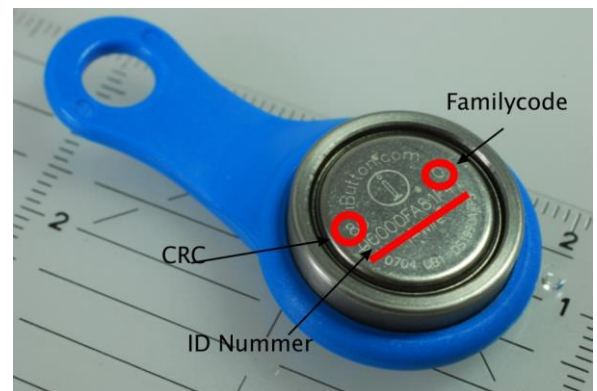
Abbildung 4: Bedeutung der aufgelaserten Beschriftung des Schlüssels
