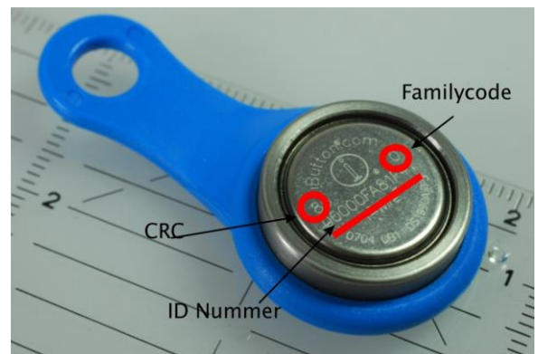
Abbildung 4: Bedeutung der aufgelaserten Beschriftung des Schlüssels
